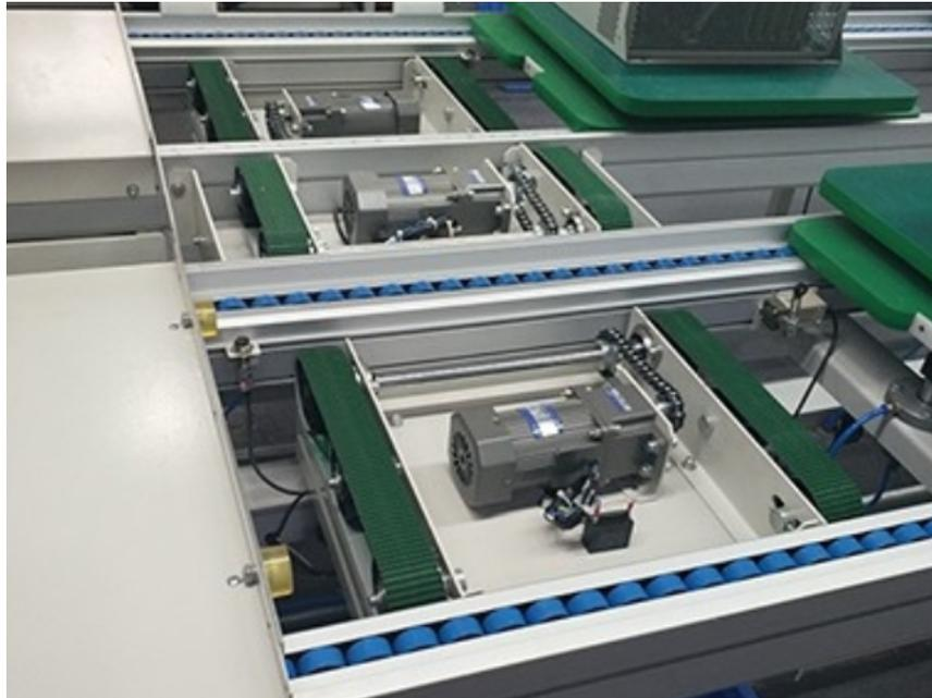
倍速链子输送线是在特制的铝型材导轨中，安装塑料复合辊式倍速链条构成的输送设备。物品托盘放置在倍链条上，被输送物品放在托盘上或通过支撑器具放托盘上。托盘的运行速度是链条运行的整倍数。由于链条是复合辊结构，在链条不停在运行中，设置在输送路线上的阻挡器使托盘停止运行。底面是大平面的物品不用托盘。这一特点更适合自由节拍的流水线的生产工作中。工位可设置气动阻挡器、脚踏开关、线内顶升旋转、顶升移行以及各种装配、检测设备，工装板上也可根据产品的生产工艺配置各种工装夹具，实现产品的自动化生产。输送方式由单排链式、双排链式、三排链式并可随意组合倍速链输送机采用的输送链条为复合辊式倍速链条，通常用的有：2.5倍速链、3倍速链。倍速链输送机通常的工装板有：铝制工装板、pvc工装板、集电板、双层可旋转式工装板等。倍速链输送机通常用到的气动阻挡器有：机械式限位器、弹簧缓冲式限位器、液压缓冲式限位器。
