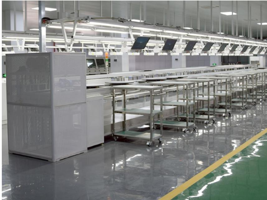
家电组装线参数：线体部分（L25m\*2条）：1) 线体导轨采用专门的铝型材，规格：118\*100。2) 链条采用目前国内苏州产三倍速工程塑胶链。3) 机架采用40\*40铁方通制作，落地脚杯±30mm可调。4) 电源插座为曼科牌二位多功能排插，采用1.4mm冷板折制作作为线槽，规格40\*60mm，安装在置物台左右边台板下方，每米1个，共50套。5) 线体工作面高度750±30mm。6) 灯架上配有6分气管，每工位一个快速接咀双边安装。7) 灯管支架采用40\*40铁方通制作，28W单支节能日光灯双边安装。8) 文件看板绿色为底，透明为面，每工位配T1m\*300\*400透明有机玻璃1块；。9) 中间置物台板为上下两层采用18mm木夹板制作，表面贴白色防火板，四周“T”胶条包边，规格为L25m\*W600mm。倍速链流水线由于安装时已经进行较为完善的调整，相对于差速链流水线在制造噪音方面比较少。徐州重型倍速链
